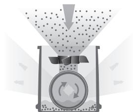
Воздухоочиститель с водяной завесой дает воздуху возможность насыщаться влагой при контакте с большими поверхностями вращающихся увлажняющих дисков. Увлажнение воздуха происходит по принципу саморегулирующегося холодного испарения воды. Дополнительные устройства управления не требуются. В качестве асептического средства рекомендуется использовать специальную добавку. Необходима регулярная очистка.
