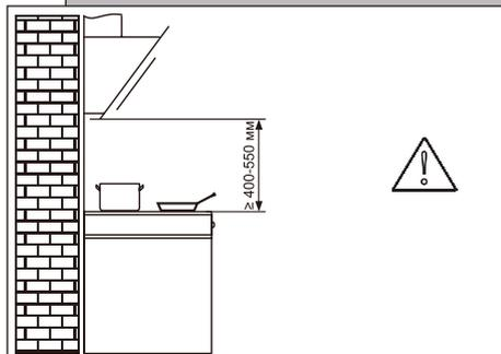
Расстояние между варочной поверхностью и нижней частью вытяжки должно быть 400-550 мм.
