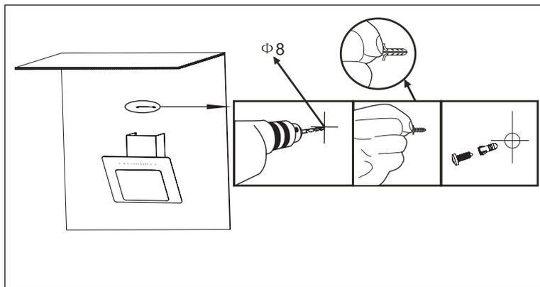
Используя трафарет сделайте два отверстия в стене диаметром 8 мм. Затем вставьте в отверстия дюбели, идущие в комплекте, и зафиксируйте саморезы.
