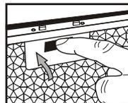
Отключите питание. Используйте плоскую отвертку для того, чтобы вытащить лампу из гнезда. Затем отсоедините разъемы лампы, Присоедините разъемы к новой лампе и вставьте лампу в гнездо до щелчка.
