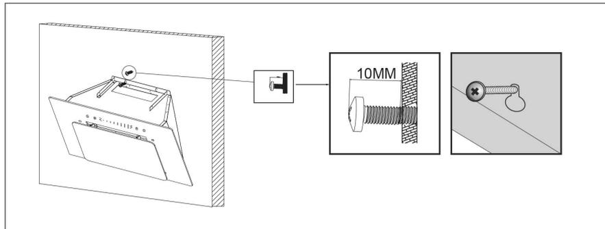
Повесьте воздухоочиститель таким образом, чтобы саморезы попали в отверстия. Затем отрегулируйте положение.
