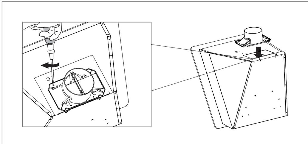
Перед установкой воздухоочистителя, пожалуйста, установите и зафиксируйте обратный клапан на выходе воздушного потока, как показано на рисунке.
