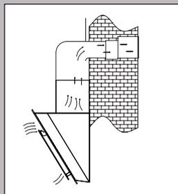
Если подобный вентиляционный канал не предусмотрен, возможно сделать горизонтальный отвод через стену.
