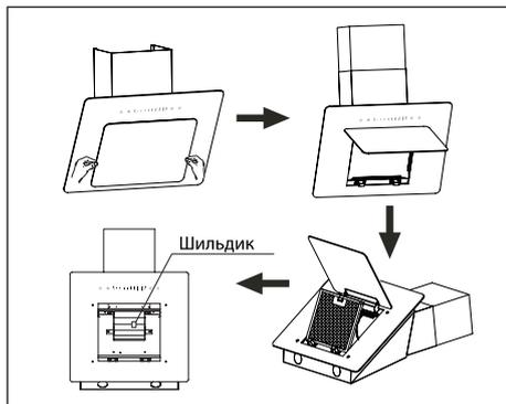
Технические характеристики указаны на шильдике, на внутренней стороне воздухоочистителя.
