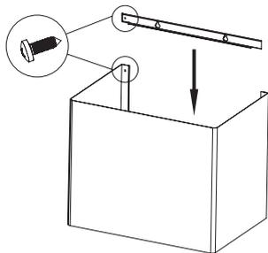
Зафиксируйте кронштейн крепления дымохода и прикрепите элемент дымохода с помощью саморезов 4\*10, как показано на рисунке.
