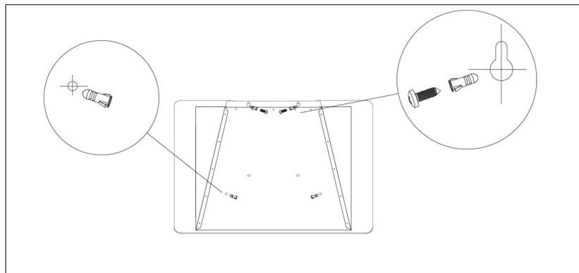
Необходимо поместить шаблон на место установки вытяжки и отметить отверстия на стене. Затем просверлите в стене отверстия диаметром 6 мм. Поместите дюбеля в отверстия и вставьте саморезы.
