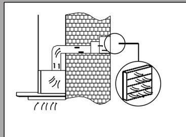
Если подобный вентиляционный канал не предусмотрен, возможно сделать горизонтальный отвод через стену.
