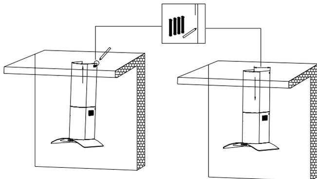
Закрепите дымоход в соответствии с размером вентиляционного канала и проверьте положение обеих труб дымохода.
