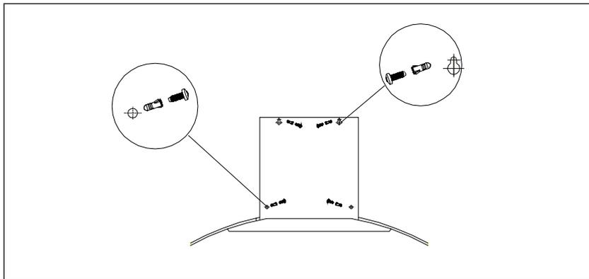
Повесьте воздухоочиститель таким образом, чтобы саморезы попали в отверстия. Затем отрегулируйте положение.
