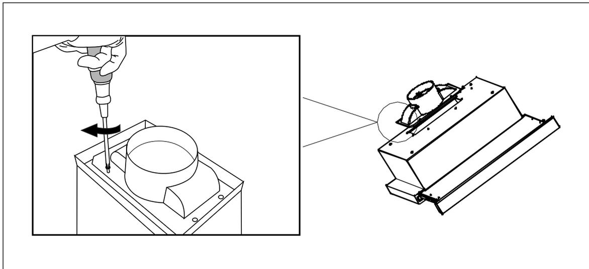
Присоедините гофрированную трубу для направления воздушного потока в вентиляционный канал.
