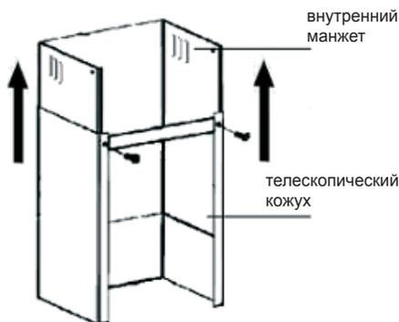
4. Установите крепежную скобу на стене по аналогии с установкой крепления вытяжки. Перед установкой кожуха подключите вытяжку к электросети. Установите и соедините кожух с вытяжкой и крепежной скобой с помощью винтов.
