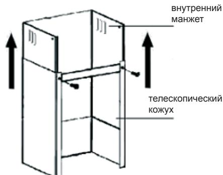
4. Установите крепежную скобу на стене по аналогии с установкой крепления вытяжки. Перед установкой кожуха подключите вытяжку к электросети. Установите и соедините кожух с вытяжкой и крепежной скобой с помощью винтов.
