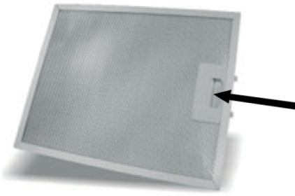
Фильтр можно мыть вручную или же в посудомоечной машине в режиме «Бережное мытье». Не мойте сильно загрязненные алюминиевые жироулавливающие фильтры в посудомоечной машине одновременно с другой посудой! Для того, чтобы промыть фильтр вручную, предварительно замочите его в горячей мыльной воде. Затем удалите щеткой оставшуюся грязь. Тщательно прополоските фильтр и дайте ему просохнуть, прежде чем установить обратно в вытяжку.
