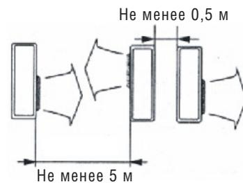
Если кондиционер монтируется на открытой площадке, например, крыше, постарайтесь расположить его таким образом, чтобы он не находился в зоне действия преобладающего направления ветра. Для этого вы можете воспользоваться ограждениями на крыше или расположить кондиционер таким образом, чтобы основная ветровая нагрузка приходилась на боковые стороны кондиционера.
