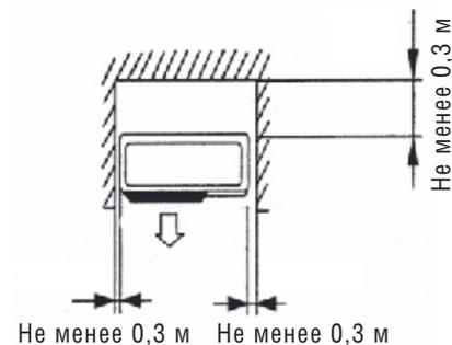
Если свободной циркуляции воздуха препятствует только 2 ограждения, расположенные по направлению движения воздуха, убедитесь в достаточном для циркуляции воздуха пространстве, согласно приведенному ниже рисунку.
