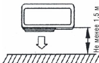
В случае установки наружного блока в нише, убедитесь в достаточном для циркуляции воздуха пространстве, согласно приведенному ниже рисунку.
