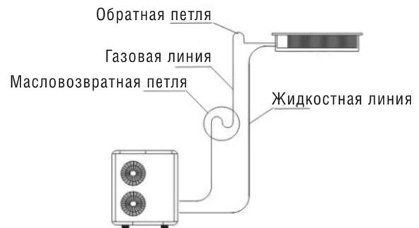
После завершения монтажа фреоновых магистралей проведите их вакуумирование. Далее заполните систему нейтральным газом до 3,0 МПа и убедитесь в том, что это давление не изменилось в течение 24 часов. В противном случае определите место утечки и устраните неисправность.
