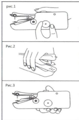
5. Включите устройство, передвинув переключатель On/Off вперед большим пальцем руки. Левой рукой держите ткань и контролируйте направление и скорость, с которой Вы протаскиваете ее через устройство. Не протаскивайте материал через устройство слишком быстро. Если требуются широкие стежки, потяните ткань влево немного быстрее во время шитья. Следуйте осевой линии на ткани крепежного зажима, чтобы обеспечить прямую строчку (рис.4)
