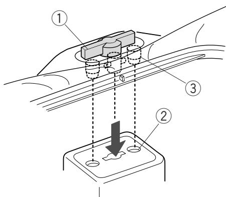
Поверните установочный винт так, чтобы он был параллелен пяльцам, и установите его на каретку. Установите пяльцы, сопоставив штифты с отверстиями в каретке.
