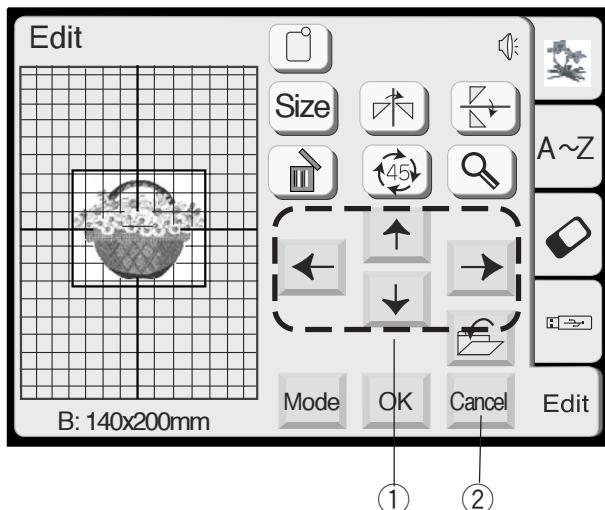
Вы можете перемещать выбранный рисунок при помощи клавиши Расположения.
