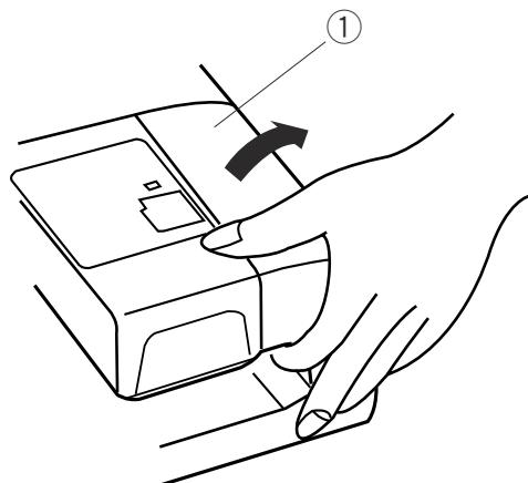
Снимите приставной столик при работе с дополнительными пальцами С.
