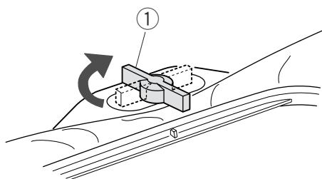
Поверните установочный винт по часовой стрелке.
