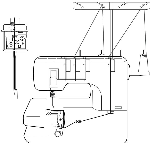
Этот шов прошивается одной иглой и формирует цепочку из нити петлителя на обратной стороне ткани. Этот прочный и подвижный стежок используется для обработки трикотажа, пришивания резинки, косой бейки и т.д.
