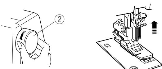
Поднимите рычаг прижимной лапки.
