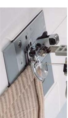
Обеспечивает необходимое положение лапки для обработки деталей изделия с изменяемой толщиной, например, в начале шва или при пересечении швов.
