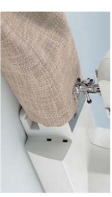
Съемная панель позволяет плоскую платформу машины преобразовать в цилиндрическую, что очень удобно при обработке цилиндрических деталей: рукавов, штанин, а также для пришивания карманов.
