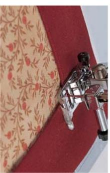
Не требуется поворачивать маховик, чтобы опустить иглу. При обработке углов выберите «останов иглы в нижнем положении» и поверните ткань соответственно, при обработке прямых швов выберите «останов иглы в верхнем положении».
