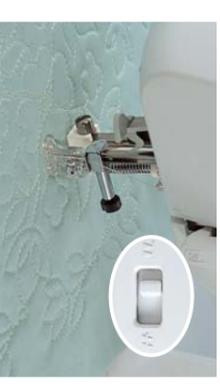
Рычаг опускания рейки используется для свободной подачи ткани при стегании, вышивке и выстрачивании монограмми.
