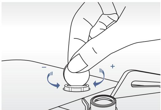
Регулятор давления прижимной лапки находится с левой стороны на корпусе машины.
