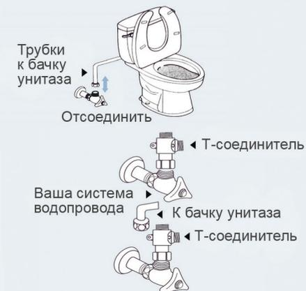
4. Присоедините Т-соединитель с трубкой крышки-биде.
