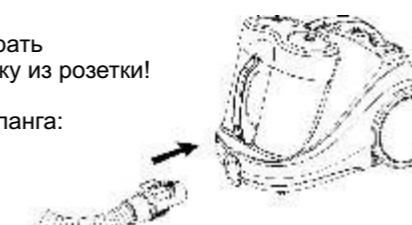
Вставьте соединительную муфту шланга в отверстие на фронтальной части корпуса. Надавите на муфту, пока она не встанет на место.
