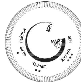
«Мин» - минимальная температура нагрева утюга. *Автоматическая настройка отсутствия пара.*
