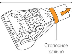
Переверните насадку и сдвиньте в направление к себе фиксирующее (стопорное) кольцо.
