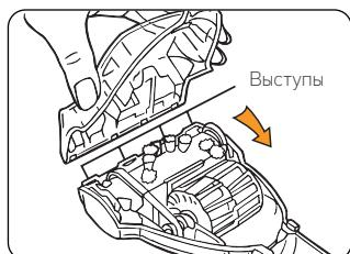
Обратно соберите Турбощетку, прикрепив нижнюю крышку к верхней части насадки. Убедитесь, что выступы внизу крышки вошли в отверстия на верхней части Турбощетки. Сдвиньте обратно на место в направление от себя фиксирующее (стопорное) кольцо.
