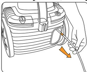
**ПРИМЕЧАНИЕ:** Перед использованием размотайте шнур на полную длину. Желтая отметка на шнуре показывает рекомендуемую длину шнура. Не разматывайте шнур далее красной отметки.
