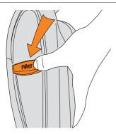
Нажмите на кнопку для снятия фильтра и извлеките пылесборник из пылесоса.
