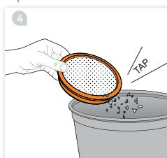
Постукиванием удалите пыль из фильтра. Промойте под проточной водой и дайте высохнуть в течение 24 часов.
