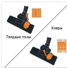
Для уборки ковров передвиньте переключатель щетки вперед. Для уборки полов с твердым покрытием передвиньте переключатель щетки назад.
