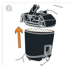
Поднимите крышку для доступа к предмоторному фильтру.
