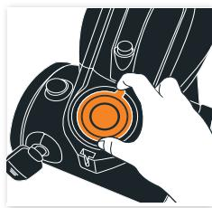
Поворотом ручки регулирования мощности отрегулируйте мощность всасывания пылесоса в соответствии с типом поверхности.
