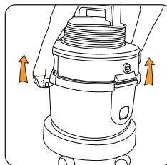
Снимите моторный блок.
