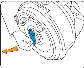
Снимите моторный блок.
