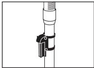
телескопическая всасывающая труба с фиксатором для стоячного положения и кронштейном для закрепления запорного клапана
