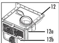
деталь АКВА-фильтра (12) с пористым фильтром (12а) и всасывающим фильтром-кубиком (12b) \*
