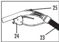
всасывающий шланг (23) с интегрированным распылительным шлангом, запорным клапаном (24) и механическим регулятором силы всасывания (25)
