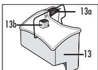
резервуар для грязной воды (13) с «мокрым» фильтром (13а) и поплавком (13b) \*
