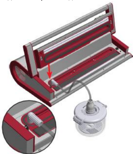
Рис. 10: Описание вакуумной закупорки вакуумных контейнеров.
