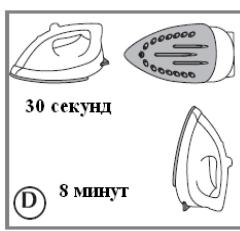
Үтікті автоматты сөндіру функциясы келесідей тәсілмен жүзеге асады: Белгілі бір температураға дейін қыздырылған, бірақ, қолданылмаған үтік, сондай-ақ, табанында жатқан немесе бір қырынан жатқан үтік 30 секундтан кейін автоматты түрде сөнеді. Егер үтік пайдаланылмаса және таяныштіректі тігінен тұрса, - автоматты түрде сөну режимі 8 минуттан кейін қосылады ( D сурет). Үтіктің автоматты отключение қызбаның индикатора жылжытымен және дыбыстық құлақтандыр- (6) қоса беріледі.
