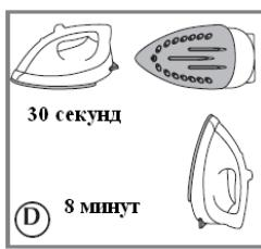
Үтікті автоматты сөндіру функциясы келесідей тәсілмен жүзеге асады: Белгілі бір температураға дейін қыздырылған, бірақ, қолданылмаған үтік, сондай-ақ, табанында жатқан немесе бір қырынан жатқан үтік 30 секундтан кейін автоматты түрде сөнеді. Егер үтік пайдаланылмаса және таяныштіректі тігінен тұрса, - автоматты түрде сөну режимі 8 минуттан кейін қосылады ( D сурет). Үтік автоматты түрде өшкен кезде дыбыстық сигнал естіледі.
