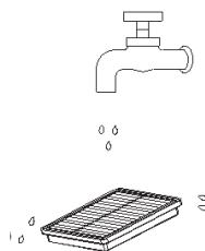
Почистите фильтр щеткой. При сильном загрязнении промойте его прохладной водой под краном. Запрещается мыть фильтр горячей водой или использовать для его мытья моющие средства. Запрещается стирать фильтр в стиральной машине.
