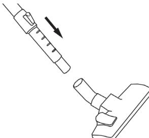
4 Установите на трубку подходящую насадку.
