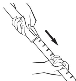
3 Отрегулируйте длину телескопической трубки.
