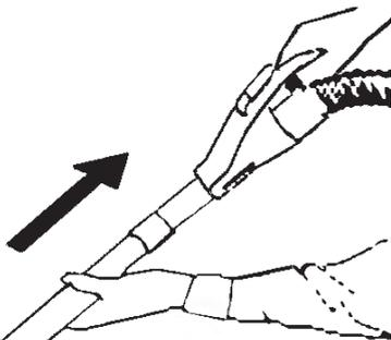
2 Соедините телескопическую трубку с ручкой гибкого шланга.
