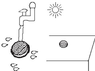
Дайте фильтру полностью высохнуть в течение 24 часов. Запрещается сушить фильтр с помощью фена или на батарее.
