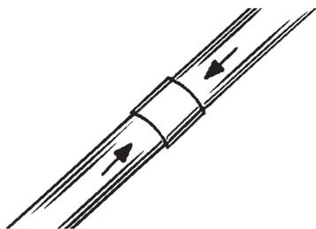
3 Отрегулируйте длину телескопической трубки.
