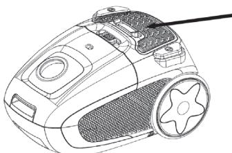
Извлеките фильтр. Промойте его прохладной водой под краном. Запрещается мыть фильтр горячей водой или использовать для его мытья моющие средства.
