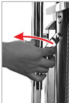
2. Выдвиньте диагональную планку и закрепите ее фиксатором.
