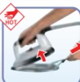
Снять насадку SOFTPRESSING ещё горячей и очистить её
