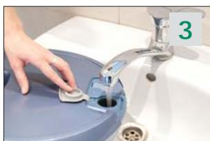
Отсек грязной воды (серый с надписью Dirty) заполните наполовину чистой водой.
