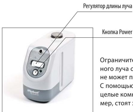
Ограничитель движения (Virtual Wall®) с помощью инфракрасного луча создает невидимую границу, которую робот не может пересечь.
