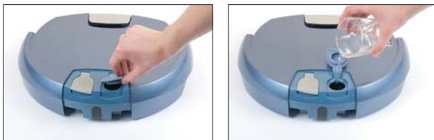
Залейте в отверстие под голубой крышкой с надписью CLEAN 7мл моющего средства для Scooba, туда же холодную чистую воду из-под крана. Убедитесь, что отсек заполнен, наклонив его. Плотнo закройте крышки Clean и Dirty.
