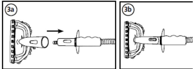
Присоедините прибор для чистки окон к удлинителю шланга следующим образом: Снимите насадку швабры нажатием блокирующей кнопки на основном корпусе или снимите струнную насадку, проделав такую же процедуру.
