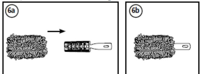
7. Присоедините каркас насадки для уборки пыли к удлинителю шланга следующим образом: Установите блокирующую кнопку на удлинителе шланга в обозначенное отверстие на каркасе насадки для уборки пыли, затем вдавите удлинитель шланга, пока он не замкнется на месте (как показано на рис.7б).
