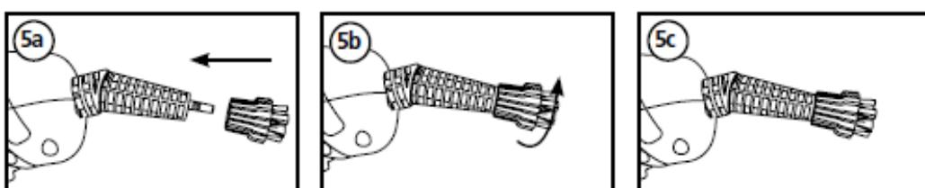
Для того чтобы снять круглую щетку, открутите ее со струйной насадки.
