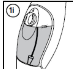
Убедитесь, что медный конус внутри контейнера для воды полностью погружен в воду (как изображено на рис.1i) в процессе использования H2O MOP X5 Elite.
