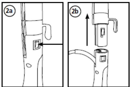
4) Для закрепления струйной насадки: Устанавливайте струйную насадку в обозначенное отверстие основного корпуса до тех пор, пока он не закрепится на месте при помощи блокирующей кнопки, расположенной на основном корпусе (Вы услышите щелчок), как обозначено на рис.4а.
