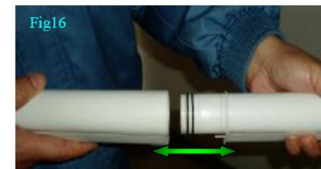
Нажмите кнопку фиксации и вставьте (не до конца) одну трубку в другую (Рис. 16).
