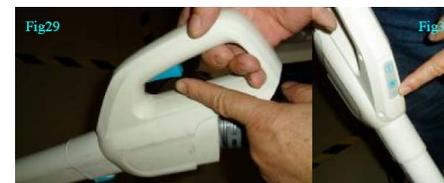
4. Нажмите на кнопку разбрызгивания воды, чтобы начать распылять воду (Рис. 29). При этом загорится индикатор на ручке.
