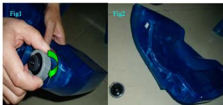
Открутите крышку с клапаном резервуара для воды (Рис. 1 и Рис. 2).
