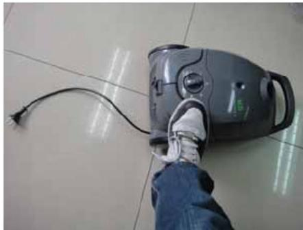
6. Для того чтобы убрать сетевой шнур, одной рукой нажмите кнопку автоматической смотки шнура, а другой рукой придерживайте шнур для обеспечения равномерной намотки.
