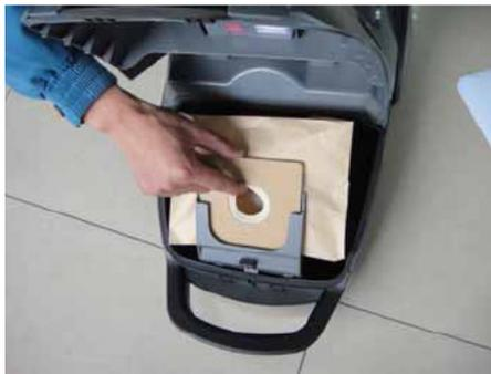
Взявшись за картонку, достаньте пылесборник из пылесоса и установите новый. Если используется матерчатый пылесборник, то его можно почистить, вымыть водой, полностью высушить и установить заново. Закройте верхнюю крышку пылесоса.
