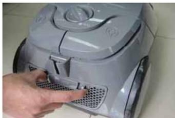
Откройте верхнюю крышку пылесоса и достаньте пылесборник, а затем фильтр двигателя.
