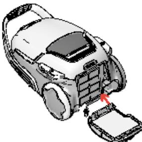
**7.** Pokud se víčko filtru uvolní, opravte jej tak, že nastavíte spodní část se závesem a zatlačte na víčko filtru, dokud nezaklapne zpět na místo.
