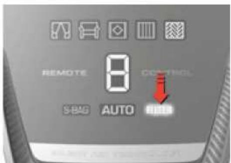
**1. Modeli s indikatorom napunjenošću filtra FILTER (+/- zasion i modeli s daljinskim upravljanjem).** Zamjenite/ocistite\* filter kad indikator napunjenošću filtra "filter" svijetli. \*samo prvi filter
