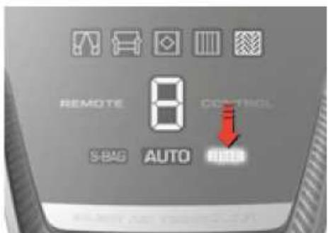
**1. Modely s kontrolkou „FILTER“** (modely s displejem +/- a dálkovým ovládáním). Vyměňte/vyčistěte\* filtr, když se rozsvítí kontrolka „filtru“. \*pouze umyvatelný filtr
