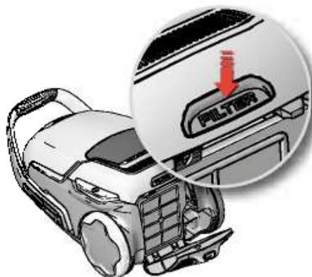
3. لفتح خدام الفلتر قم بالضغط على زر FILTER أسبق المكسة. يرجى استخدام فلتر Electrolux الأصلية: EFS 1W / EFH 12W
