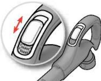
A kézi vezérlésű modelleknel a levegőszelép segítséget nyújt a szívóerő gyors csökkentésében.
