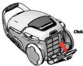
6. После замены фильтра установите крышку фильтра на место и придавите её до фиксации со щелчком.
