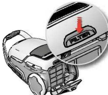
**1. Modele z kontrolką FILTER (filtr) (modele z wyświetlaczem +/- oraz zdalnym sterowaniem).** Wymień/wyczyszcz filtr, gdy zaświeci się kontrolka filtra. \*tylko filtr przeznaczony do mycia
