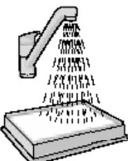
**5. Czyszczenie filtra wylotowego, który można opłukać wodą. Wewnętrzna (brudna) strona filtru należy opłukać pod kranem letnią wodą. Postukaj ramkę filtru, aby usunąć z niego wodę. Powtórz ten proces cztery razy.**
