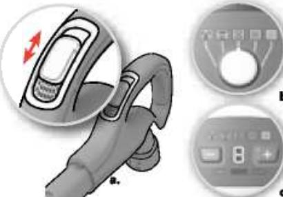
**9. Wyreguluj siłę ssania.** Modele z ręczną regulacją.
