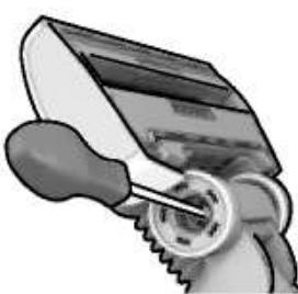
**3. Csatlakozza ki a kerékengelyt, és tisztítsa meg minden alkatrész. Az összeszereléshez végezze el a fenti műveleteket fordított sorrendben.**
