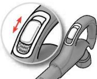
W modelach ze sterowaniem ręcznym zawór powietrny może pomóc szybko zmniejszyć siłę ssania.
