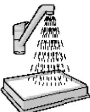
**5. Čišćenje prvega ispušnog filtra:** Operite samo unutarnju (prijevu) stran u tekućoj mlačkoj vodi. Stresite okvir filtra da biste uklonili vodu. Postupak ponovite četiri puta.
