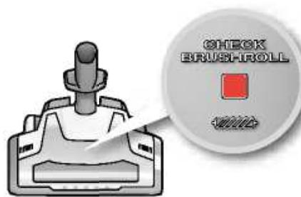
3. Ako se četka preoptereti, zasvijjeti će Indikator četke. Izvadite cjev iz nastavka, provjerite stanje četke, očistite je ako je potrebno i zatim ponovo priključite nastavak.
