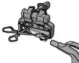
**2. Vyjměte rotační kartáč a nůžkami odstraněte namotaná vlákna. Pomocí rukojeti hadice vyčistěte hubici. Vše nasadte zpět v opačném pořadí.**
