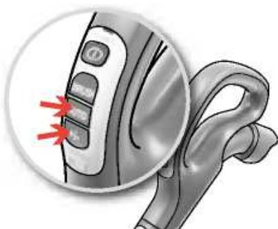
**10. Nastavte sací výkon. Modely s dálkovým ovládáním.** Vysavač začne pracovat v režimu automatické nastavení (Automatická regulácia výkonu). Chcete-li sílu sání nastavit ručne, stiskniete tlačidlo „-“ (minimum) alebo tlačidlo „+“ (maximum). Chcete-li se vrátiť do režimu automatického nastavenia, stiskniete tlačidlo AUTO.
