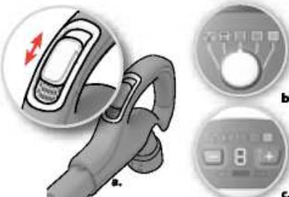
**9. Állitsa be a szívóteljesítményt.** Kézi vezérlésű modellek: a) A szívőrő gyors csökkenéséhez használja a levegőszelépet b) A szívóteljesítmény beállításához használja a porszívón lévő forgatógombot c) A szívóteljesítmény beállításához használja a porszívón elhelyezett - vagy - gombot.
