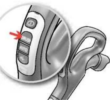
**11. Távirányítású, AeroPro motoros szívófejjel rendelkező típusok.** A motoros szívőfej bekapcsolásához nyomja meg a BRUSH (kefe) gombot a fogantyún.
