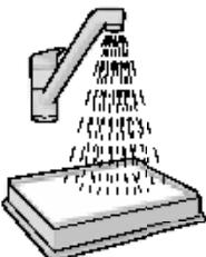
**5. Čistenie umyvatelného výstupného filtra.** Opláchnete vnútornú (znečistenú) stranu filtra vlažnou vodou. Poklepejte na rám filtra, aby voda odtekla. Tento postup opakujte čtyřikrát.
