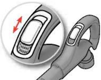
Na modelima s ručnim upravljanjem ventil za zrak može pomoći u brzom smanjivanju snage usisa.
