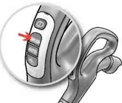
**11. Modely s dálkovým ovládáním a motorizovanou hubicí AeroPro.** Chcete-li motorizovanou hubici zapnout nebo vypnout, stiskniete tlačidlo BRUSH na rukojeti.
