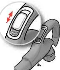
**9. Namjestite snagu usisa.** Modeli s ručnim upravljanjem. a) Za brzo smanjivanje protoka zraka upotrijebite tipku za upravljanje usisom na ručki b) Pomoću okretne tipke na usisavaču namjestite snagu usisa c) Pomoću tipke + ili - na usisavaču podesite snagu usisa.
