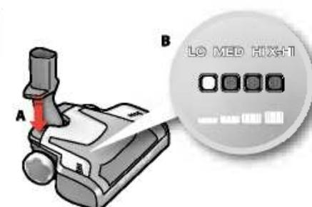
**3.** Výška čistení koberce může být upravena stisknutím (rukou nebo nohou) pedálu „height adjust“ pro změnu výšky v zadní části hubice (A). Po změně nastavení na vhodnou vzdálenost mezi povrchem a rotačním kartáčem se ukazatel výšky změní z Low na X-Hi(B).
