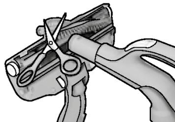
2. Wymij szczotkę rolkową i usuń zaplątane nitki i włókna, przecinając je nożyczkami. Oczyszć ssawkę, używając uchwytu węża. Włóż części z powrotem, wykonując te czynności w odwrotnej kolejności.
