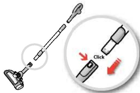
3. Присоедините телескопическую трубку к насадке для пола (чтобы снять ее, нажмите кнопку замка и снимите насадку).
