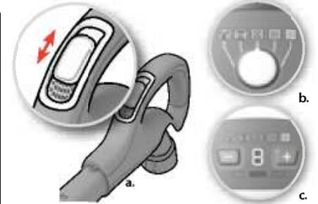
9. Подесите јачину усисавања Модели ручном регулацијом: а) Јачину усисавања можете брзо да подесите помоћу дугмета за регулацију јачине усисавања на ручци, б) Јачину усисавања можете да подесите помоћу ротирајућег дугмета на самом усисивачу, в) Јачину усисавања можете да подесите помоћу дугмади + и - на самом усисивачу.\*
