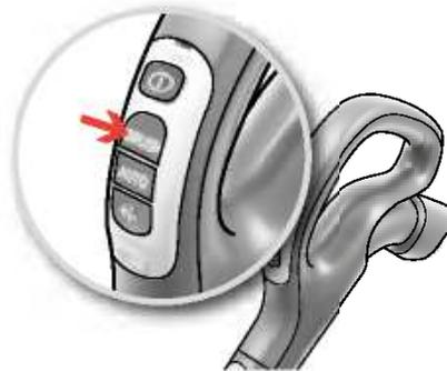
11. Модели са даљинским командама и папучицом AeroPro са мотором. Папучица са мотором се укључује и искључује помоћу дугмета „BRUSH“ на дршци.\*
