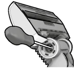
3. Odkręć oś i oczyść wszystkie części. Włóż części z powrotem, wykonując te czynności w odwrotnej kolejności.
