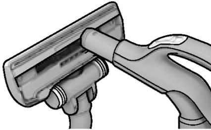
1. Skinite sapnico s cijevi. Za čiščenje sapnice upotrijebite ručku crijeva.
