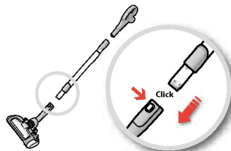
3. **Csatlakoztassa a teleszkópos csövet a szívófejhez** (eltávolításához nyomja meg a rögzítógombot, majd húzza ki a szívófejet).
