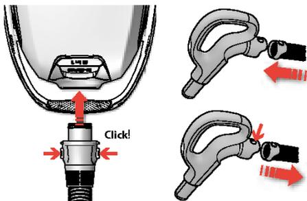
2. Вставьте шланг в пылесос (чтобы снять его, нажмите кнопки замка и вытяните шланг). Плотнo вставьте шланг в рукоятку шланга до защелкивания фиксаторов. (Для отсоединения шланга следует нажать на фиксаторы.)
