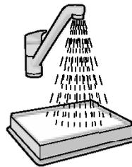
**5. Czyszczenie filtra wylotowego, który można oplaćkiwać wodą** Wewnętrzna (brudna) stronę filtra należy oplaćkić pod kraniem letnią wodą. Postukaj ramką filtra, aby usunąć z niego wodę. Powtórz ten proces cztery razy.
