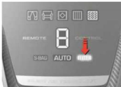
**1. Modeli s indikatorom napunjenosti filtra FILTRE** (+/- zaslom i modeli s daljinskim upravljanjem). Zamijenite/ očistite\* filter kad indikator napunjenosti filtera "filter" svijetli. \*samo perivi filteri
