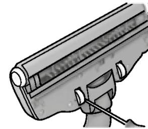
3. **Ako se zaglave kotači**, pažljivo ih odstranite pomoću malog odvijača i očistite kotače.
