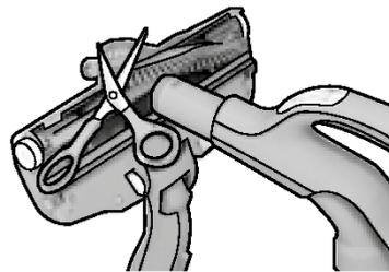
2. Izvucite valjak s četkom i uklonite zapletene niti režući ih škarama. Za čišćenje sapnice upotrijebite ručku crijeva. Sastavite obratnim redosljedom.
