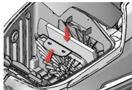
8. **Zamijenite filtar motora kad se zaprlja ili nakon svake pete zamjene vrećice s-bag®**. Gurnite držač filtra prema dolje i izvucite ga. Zamijenite filtar i zatvorite poklopac.
