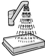
5. تنظيف الفلتر القابل للغسيل بالماء: قم بتنظيفه من الداخل (الناحية المسخخة) بالمياه القاترة من الحنفية. ثم قم بتحريك الفلتر بشكل منتظم ومكرر بعيدا عن الحنفية لتصفيته من الماء. قم بتكرار عملية التنظيف بأكملها أربعة مرات.
