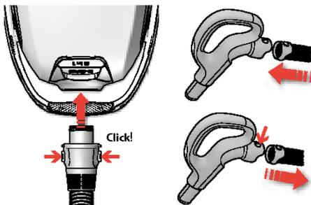
2. **Csatlakoztassa a tömlőt a készülékhez** (eltávolításához nyomja meg a rögzítógombokat, majd húzza ki a gégecsövet).
