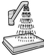
**5. Мытье мощного выпускного фильтра** Промойте фильтр изнутри (грязную сторону) теплой водой из-под крана. Слегка постучите по рамке фильтра, чтобы стряхнуть воду. Повторите процедуру четырежды.
