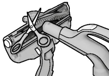
2. Húzza ki a forgókefét, és ollóval távolítsa el a rácsavarodott szálakat. A szívófej megtisztításához használja a gégecső fogantyúját. Az összeszereléshez végezze el a fenti műveleteket fordított sorrendben.
