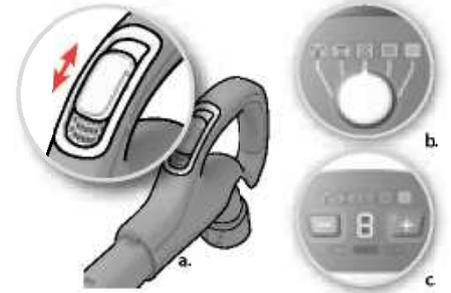
9. **Отрегулируйте мощность всасывания.** Модели с ручной регулировкой. а) Для быстрого ослабления воздушного потока воспользуйтесь воздушным клапаном на рукоятке. б) Воспользуйтесь поворотной ручкой на пылесосе для регулировки мощности всасывания. с) Воспользуйтесь кнопками «←→» для регулировки мощности всасывания.
