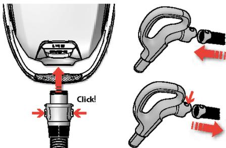
2. Umetnite cijev u usisavač (da biste ga uklonili, pritisnite gumb za zaključavanje i izvucite ga). Gurnite crijevo u ručku crijeva sve dok zapori ne dođu na svoje mjesto.
