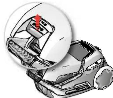
3. **Otvoríte kryt prachového oddielu zatažením za tlačítko uvoľnení sáčku „S-BAG“.**
