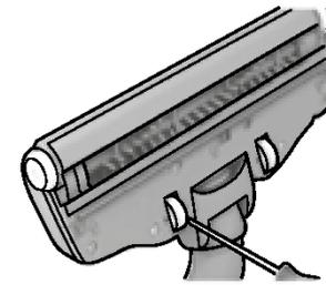
3. В случае заклинивания колесиков осторожно выньте их при помощи небольшой отвертки и произведите очистку.
