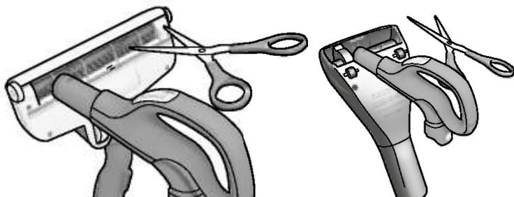
1. عملية تنظيف فوهة التيربو: (قطع بعض الموديلات) قم بفصل الفوهة عن أنبوب الضغط ثم قم بإزالة كراكات الورق، على حبل السهل: باستخدام مكنس. أيضا يمكنك استخدام خرطوم الضغط لتنظيف الفوهة.
