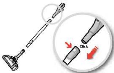
4. **Csatlakoztassa a teleszkópos csövet a gégecső fogantyújához** (eltávolításához nyomja meg a rögzítógombot, majd húzza ki a gégecső fogantyúját).
