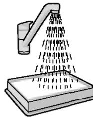
**5. Čištění omyvatelného výstupního filtru.** Opláchněte vnitřní (znečištěnou) stranu filtru vlažnou vodou. Poklepejte na rám filtru, aby voda otekla. Tento postup opakujte čtyřikrát.
