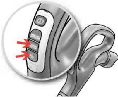
**10. Nastavte sací výkon. Modely s dálkovým ovládním.** Vysavač začne pracovat v režimu automatické nastavení (Automatická regulace výkonu). Chcete-li sílu sání nastavit ručně, stiskněte tlačítko „-“ (minimum) nebo tlačítko „+“ (maximum). Chcete-li se vrátit do režimu automatického nastavení, stiskněte tlačítko AUTO.
