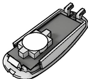
**2.** Używaj tylko baterii typu LITHIUM CR1632. Przed użyciem odkurzacza baterie muszą być usunięte. Należy zadbać o ich bezpieczną utylizację.
