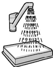
**5. Čišćenje perivog ispušnog filtra** Operite samo unutarju (prljavu) stranu u tekućoj mlakoj vodi. Stresite okvir filtra da biste uklonili vodu. Postupak ponovite četiri puta.
