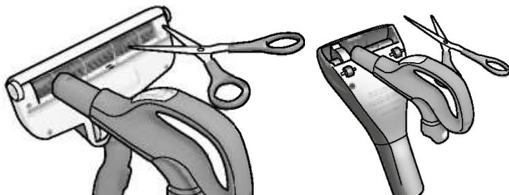
**1. Czyszczenie ssawki Turbo** (tylko niektóre modele)
