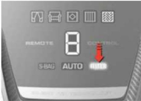
**1. Modele z kontrolką FILTER (filtr)** (modele z wyświetlaczem +/- oraz zdalnym sterowaniem). Wymień/wyczyść filtr, gdy zaświeci się kontrolka filtra. *\*tylko filtr przeznaczony do mycia*
