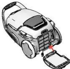
7. Pokud se víčko filtru uvolní, opravte jej tak, že nastavíte spodní část se závěsem a zatlačíte na víčko filtru, dokud nezaklapne zpět na místo.
