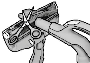
2. Húzza ki a forgókefét, és ollóval távolítsa el a rácsavarodott szálakat. A szívófej megtisztításához használja a gégecső fogantyúját. Az összeszereléshez vegye el a fenti műveleteket fordított sorrendben.
