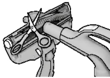
2. Vyjměte válcový kartáč a odstříhnete namotané nitě. Hubici vyčistěte pomocí koncovky hadice. Vraťte součásti na místo v obráceném pořadí.
