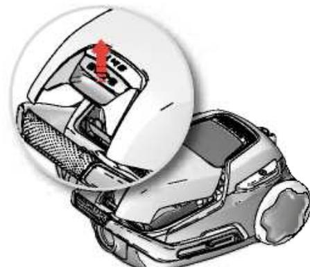
3. Откройте крышку отсека для сбора пыли, нажав на кнопку «S-BAG» и потянув крышку вверх.
