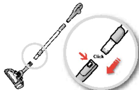
3. **Csatlakoztassa a teleszkópos csövet a szívófejhez** (eltávolításához nyomja meg a rögzítőgombot, majd húzza ki a szívófejet).
