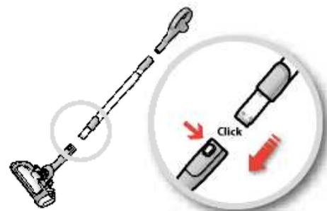
3. Присоедините телескопическую трубку к насадке для пола (чтобы снять ее, нажмите кнопку замка и снимите насадку).
