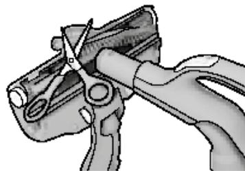
2. Wyjmij szczotkę rolkową i usuń zaplątane nitki i włókna, przecinając je nożyczkami. Oczyszć ssawkę, używając uchwytu węża. Włóç części z powrotem, wykonując te czynności w odwrotnej kolejności.
