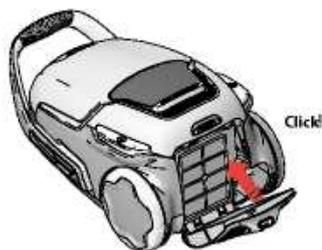
6. После замены фильтра установите крышку фильтра на место и придавите её до фиксации со щелчком.
