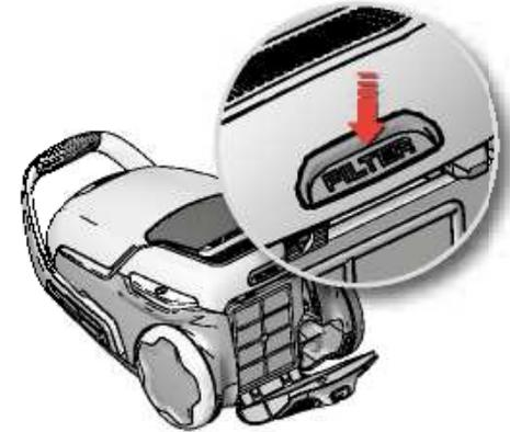
**3. Otevřete víčko filtru stisknutím tlačítka „FILTER“** na zadní straně vysavače. Používejte pouze originální filtry značky Electrolux: EFS 1W / EFH 12W.
