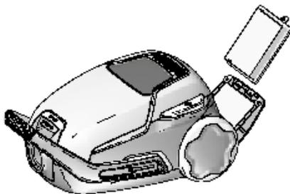
**4. Wyciągnij filtr i sprawdź typ filtra na podstawie koloru ramki.** Zielony: wymaga wymiany na nowy filtr. Niebieski: wymaga wymiany na nowy filtr lub wyzyszczenia, patrz punkt 5 (filtr przeznaczony do mycia).
