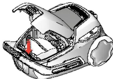
5. Вставьте новый пылесборник s-bag®, протолкнув картонный держатель вдоль направляющих вниз до упора. Закройте крышку. Если пылесборник s-bag® вставлен неправильно или отсутствует, крышка не закроется.
