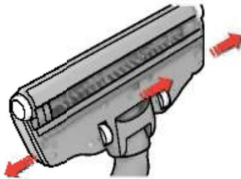
1. Zatlačte na západky a otevřete kryt válcového kartáče. Tím se přední kolečka uvolní a můžete je vyčistit.
