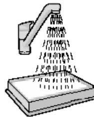
**5. Czyszczenie filtra wylotowego, który można opłukiwać wodą.** Wewnętrzną (brudną) stronę filtra należy opłukiwać pod kranem letnią wodą. Postępuj ramką filtra, aby usunąć z niej wodę. Powtórz ten proces cztery razy.
