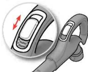
A kézi vezérlésű modelleknél a levegőszelep segítséget nyújt a szívóerő gyors csökkentésében.
