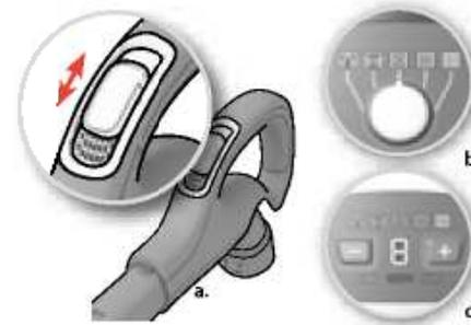
**9. Namjestíte snagu usisa.** Modeli s ručním upravljanjem. a) Za brzo smanjivanje protoka zraka upotrijebite tipku za upravljanje usisom na ručki b) Pomocu okretne tipke na usisavaču namjestite snagu usisa c) Pomocu tipke + ili - na usisavaču podesite snagu usisa.
