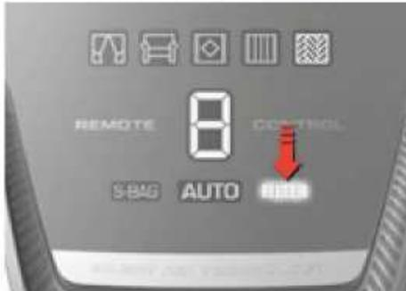
**1. SZÜRŐ visszajelzővel ellátott modellek** (+/- kijelző és távvezérlős modellek). Amikor a "szűrő" visszajelző világít, cserélje ki/tisztítsa meg\* a szűrőt. \*csak a mosható szűrők esetén
