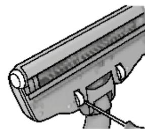
3. **Ako se zaglave kotači**, pa/ livo ih odstranite pomoću malog odvijača i očistite kolače.
