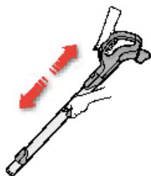
5. Отрегулируйте телескопическую трубку, держа замок одной рукой и нажимая рукоятку другой.
