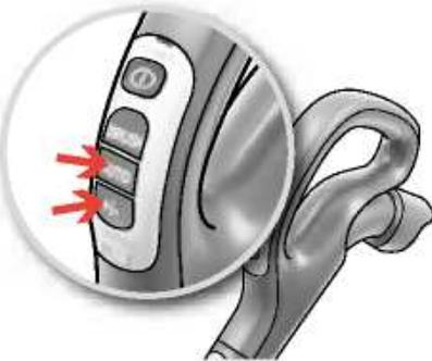
10. Állítsa be a szívóteljesítményt (távirányított típusoknál). A porszívó az automata funkcióval (automatikus teljesítmény-szabályzás) indul el. A kézi szabályozáshoz nyomja meg a „-” (minimum) vagy „+” (maximum) gombot. Az automata funkcióhoz az AUTO gomb megnyomásával térhet vissza.
