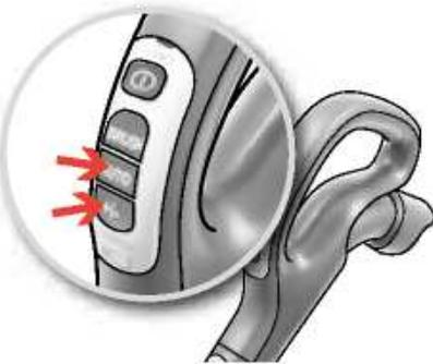
10. Отрегулируйте мощность всасывания. Модели с дистанционным управлением. Пылесос запускается в авторежиме (автоматическое управление мощностью). Для ручной регулировки нажмите кнопку “-” (минимум) или кнопку “+” (максимум). Для возврата в авторежим нажмите кнопку AUTO.
