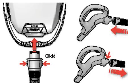
2. Вставьте шланг в пылесос (чтобы снять его, нажмите на кнопку замка и вытяните шланг). Плотнo вставьте шланг в рукоятку шланга до защелкивания фиксаторов. (Для отсоединения шланга следует нажать на фиксаторы.)
