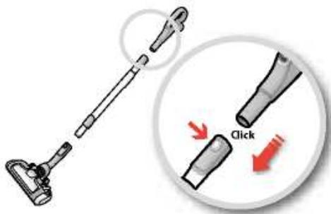
4. Присоедините телескопическую трубку к рукоятке шланга (чтобы снять ее, нажмите кнопку замка и вытяните рукоятку шланга).
