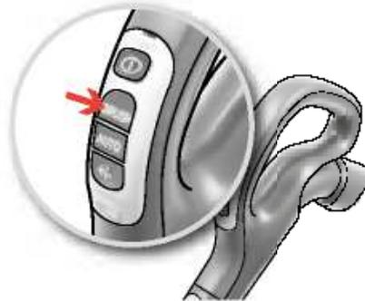
11. Моделу са даљинским командама и папуџицом AeroPro са мотором. Папуџица са мотором се укључује и искључује помоћу дугмета „BRUSH“ на дршци.\*
