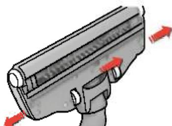
1. Otvorite poklopac valjka s četkom pritiskom na spojnice. Tako ćete osloboditi prednje kotačiće za čišćenje.
