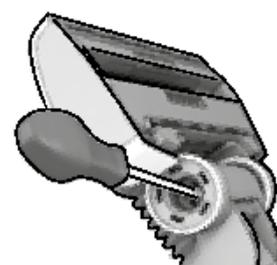
3. Odvijte osovinu kotačića i očistite sve dijelove. Sastavite obratnim redoslijedom.
