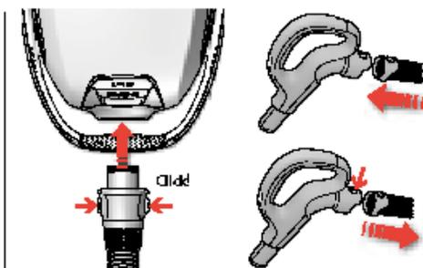
2. **Zasuňte hadiči do vysavače** (chcete-li jivymout, stiskněte pojistné tlačítko a hadiči vytáhněte). Zasuňte hadiči do držáku tak, aby západky zaklaply a upevnily ji (stisknutím západek hadiči uvolníte).
