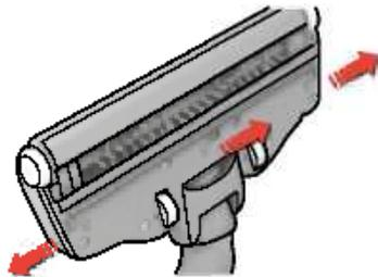
1. Откройте крышку щетки-ролика, нажав защелки. Передние колеса будут при этом открыты для чистки.
