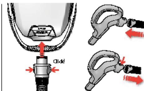
2. **Csatlakoztassa a tömlőt a készülékhez** (eltávolításához nyomja meg a rögzítőgombokat, majd húzza ki a gégecsövet).
