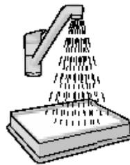
**5. Мытье мощного выпускного фильтра** Промойте фильтр изнутри (в разную сторону) тонкой струей из под крана. Силька постукивание о рамаке фильтра, чтобы стряхнуть воду. Повторите процедуру четырежды.
