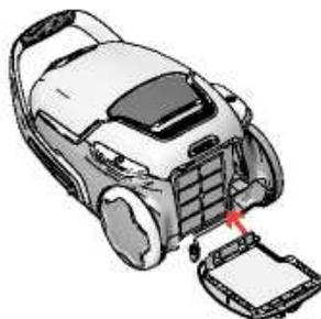
7. В случае ослабления фиксации крышки фильтра заново установите её, поместив крышку стороной с крючками в соответствующие пазы, затем нажмите на крышку до фиксации на месте со щелчком.
