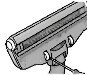
3. В случае заклинивания колесиков осторожно выньте их при помощи большой отвертки и произведите очистку.
