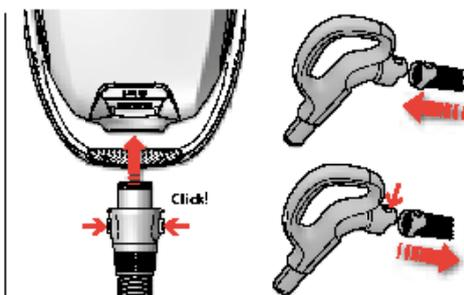
2. **Umetnite cijev u usisavač** (da biste ga uklonili, pritisnite gumb za zaključavanje i izvucite ga).
