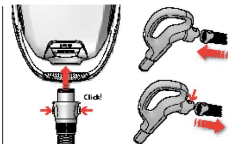
2. Podłącz węz do odkurzacza (aby go odłączyć, naciśnij przyciski blokujące i wyciągnij węz). Włóż węz do uchwyty, aż usłyszysz odgłos zatrzaśnięcia zapadki (aby go wyjąć, wcisnij zapadkę).
