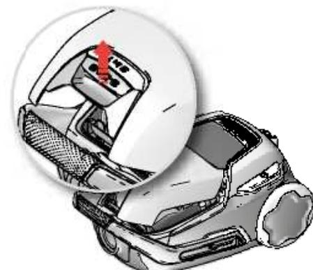
3. **Otvoríte kryt prachového oddielu zariadením za tlačítko uvoľnenia sáčku „S-BAG“.**
