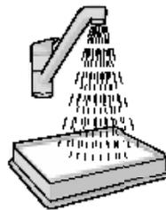
**5. Čištění omyvatelného výstupního filtru.** Opláchněte vnější (znečištěnou) stranu filtru vlažnou vodou z vodovodu. Rám filtra zlehka oklepte, aby ste odstránili prebytočnú vodu. Zopakujte tento postup 5-krát.
