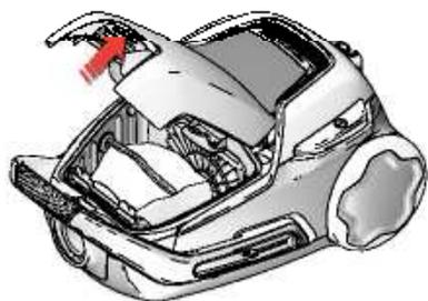
1. Otvoríte kryt prachového oddílu zatažením za tlačítko uvolnění sáčku „S-BAG“. **Zkontrolujte, zda je sáček s-bag® na svém místě.**
