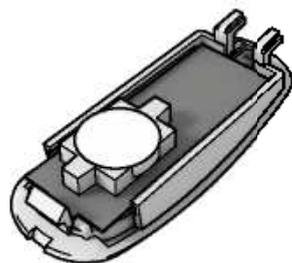
2. Пользуйтесь только литиевыми аккумуляторами CR1632. Аккумуляторы следует вынимать из прибора до того, как они придут в негодность, и утилизировать, соблюдая меры предосторожности.
