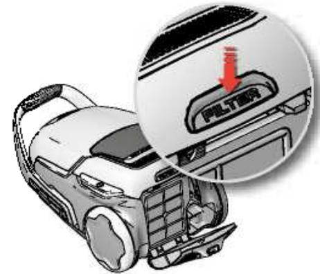
**3. Otwórz pokrywę filtra, naciskając przycisk FILTER (filtr) z tyłu odkurzacza.** Używaj oryginalnych filtrów Electrolux; EFS 1W / EFH 12W.
