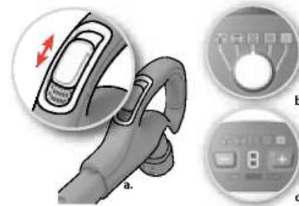
9. Namjestite snagu usisa. Modeli s ručnim upravljanjem. a) Za brzo smanjivanje protoka zraka upotrijebite tipku za upravljanje usisom na ručki b) Pomoću okretne tipke na usisavaču namjestite snagu usisa c) Pomoću tipke + ili - na usisavaču podesite snagu usisa.
