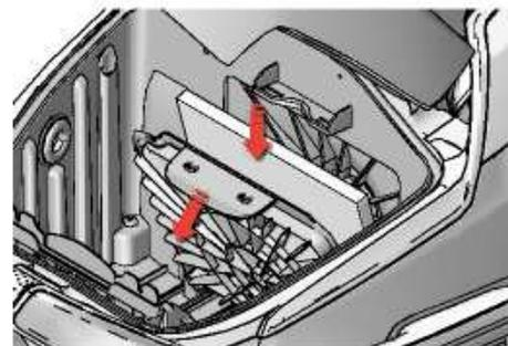
8. Filtr silnika należy wymieniać po zabrudzeniu lub przy co piątej wymianie worka S-bag®. Naciśnij uchwyt filtra, a następnie wyjmij go. Wymień filtr i zamknij pokrywę.
