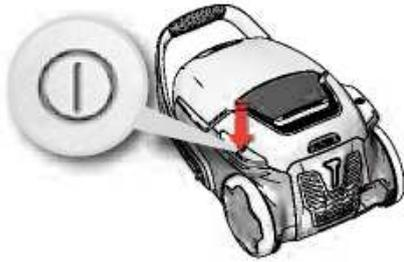
7. A porszívó elindításához illetve leállításához nyomja meg a be-/kikapcsoló gombot.
