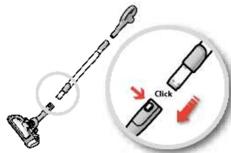
3. **Pričvrstite teleskopsku djev na podnu sapnicu** (da biste je uklonili, pritisnite gumb za zaključavanje i izvucite je).
