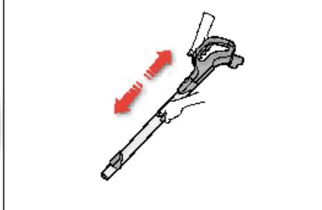
5. **Namjestite teleskopsku cijev** tako sto ćete jednom rukom držati gumbo za zaključavanje, a drugom izvuci ručku.
