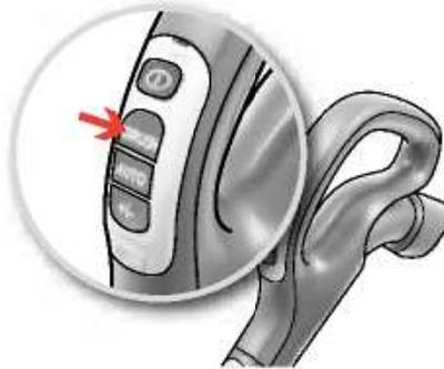
11. Модели с дистанционно управление и моторизиран накрайник Aeropro. За да включите или изключите моторизирания накрайник, натиснете бутона BRUSH, разположен върху дръжката.
