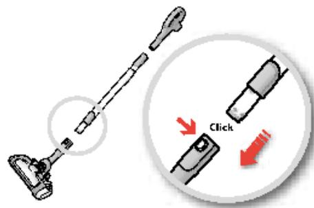
3. Podłącz rurę teleskopową do ssawki podłogowej (aby ją odłączyć, naciśnij przycisk blokujący i wyciągnij ssawkę).
