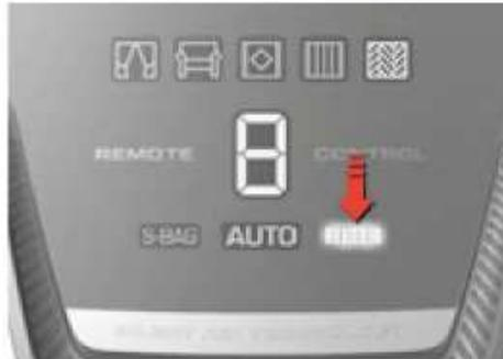
**1. Modely s kontrolkou „FILTER“** (modely s displejem +/- a dálkovým ovládním). Vyměňte/vyčistěte\* filtr, když se rozsvítí kontrolka „filtru“. \* *pouze omyvatelný filtr*
