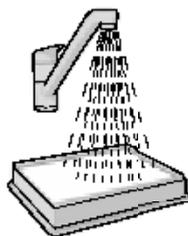
5. **Čišćenje prvog ispušnog filtra:** Oprinite samo unutrašnju (prljavu) stranu u tekucij mlakoj vodi. Srušite okvir filtra da biste uklonili vodu. Postupak ponovite četiri puta.
