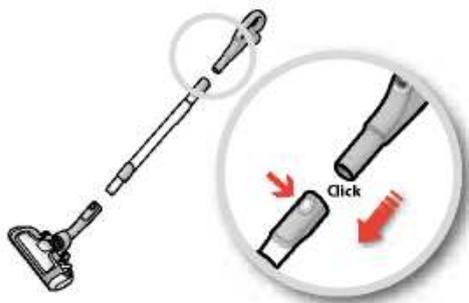
4. Podłącz rurę teleskopową do uchwyty węża (aby ją odłączyć, naciśnij przycisk blokujący i wyciągnij uchwyty węża).
