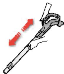
5. **Nastavte teleskopickou trubicu** – jednou rukou podržte zámek a druhou zatáhněte za rukojeť.
