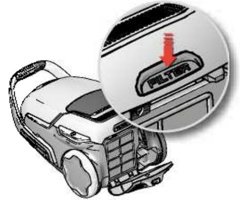
3. افتح غطاء الفلتر قم بالضغط على زر FILTER اسفل المكثف. يرجى استخدام فلاتر Electrolux الاصلية: EFS 1W / EFH 12W.
