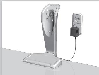
2. Вставьте адаптер в сеть и установите базу на устойчивую горизонтальную поверхность вдали от источников тепла, прямого солнечного света или влаги.
