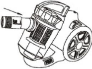
1. Выровняйте гибкий шланг относительно воздухозаборного отверстия на корпусе пылесоса, вставьте наконечник шланга в отверстие до упора, а затем поверните фиксатор по часовой стрелке на 90 градусов до фиксации.
