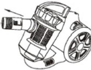
Чтобы отсоединить гибкий шланг от корпуса, поверните фиксатор против часовой стрелки на 90 градусов и потяните.
