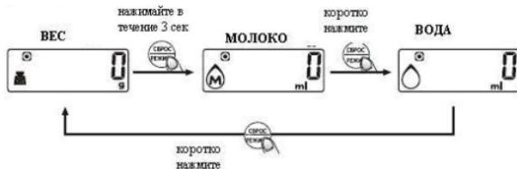
6.7. Весы выключаются автоматически, если нулевое значение или одно и то же значение веса на дисплее отображается в течение 2 минут.
