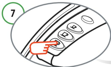
Когда машина нагревается и кнопки перестанут мигать, промойте машину двойным нажатием на кнопку «Фильтр кофе». Дождитесь пока машина завершит цикл промывки.
