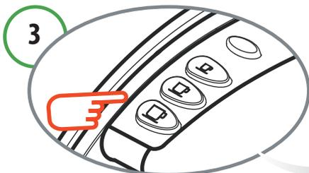
Нажмите одну из кнопок напитка (*Эспрессо, Кофе, Фильтр кофе*), и дождитесь пока машина завершит подготовительный цикл и заполнится водой.
