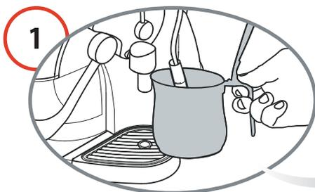
1 Подставьте металлическую емкость под трубку выдачи горячей воды.
