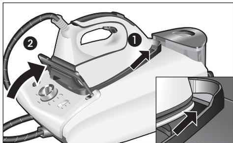
4. Слейте воду из резервуара для воды, сложите шнур питания в отделение для хранения и зафиксируйте паровой шланг в предусмотренном креплении. Не сматывайте шнуры слишком туго.
