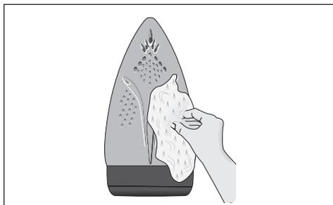
4. Если синтетическая ткань расплавилась под воздействием слишком высокой температуры подошвы утюга, отключите подачу пара и немедленно удалите налипшую ткань с помощью сухой хлопчатобумажной салфетки, сложенной в несколько слоев.
