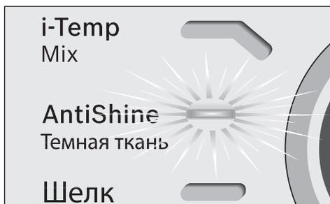
Данная паровая станция оснащена программой «AntiShine». Выбрав эту программу и регулярно нажимая на кнопку выпуска пара из подошвы (14 или 15\*), Вы снижаете вероятность появления лоснящихся следов от утюга на ткани.
