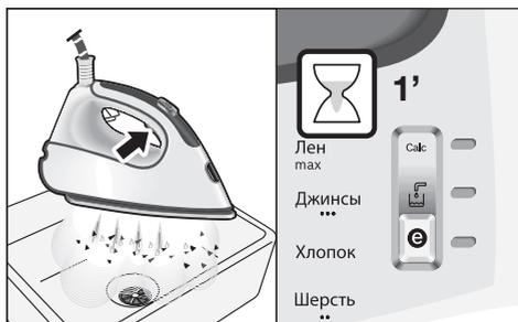
Продолжайте осторожно трясти утюг в течение пяти минут, удерживая при этом кнопку выпуска пара из подошвы нажатой, чтобы вода и пар полностью очистили камеру парообразования.
