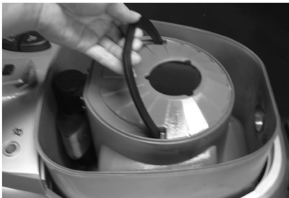
5. Entfernen des Behälters
