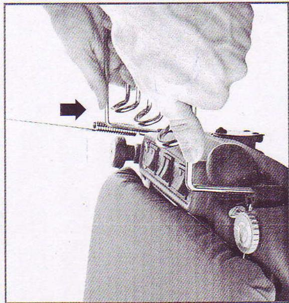
Установка утюга: после того, как доска была раскрыта, и ее положение было отрегулировано, необходимо размотать сетевой шнур с направляющих (13) и вставить вилку шнура в розетку электросети напряжением 220 В. Вставьте подставку для утюга (16) в отверстие (15) и положите на нее резиновый коврик (24). Снимите утюг с крючка, находящегося под доской (14), и вставьте его в подставку для утюга (16).
