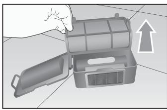
Снимите НЕРА фильтр, нажав на защелку, расположенную сбоку контейнера. Очистите его с помощью щетки.
