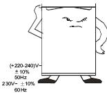
Перед включением морозильной камеры в сеть электропитания убедитесь, что напряжение и частота электросети соответствует указанным на маркировке изделия. Подключайте морозильную камеру к розетке с заземлением. Подключайте морозильную камеру только к источнику переменного тока.
