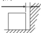
Устанавливайте морозильник в хорошо вентилируемых помещениях. Достаточная вентиляция позволяет морозильнику работать максимально эффективно при низком потреблении мощности, а также способствует отводу тепла. Для обеспечения достаточной вентиляции вокруг морозильника необходимо обеспечить свободное пространство не менее 10 см.
