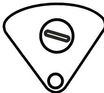
На панели управления располагается регулятор терmostата, имеющий пять положений. Данный регулятор позволяет регулировать охлаждение, при этом положения регулятора не соответствуют каким-либо конкретным температурным значениям. Поворачивайте термостат по часовой стрелке, чтобы понижать температуру внутри камеры морозильника, или поворачивайте термостат против часовой стрелки, чтобы повышать температуру.
