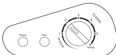
На панели управления располагается регулятор терmostата, имеющий пять положений. Данный регулятор позволяет регулировать охлаждение, при этом положения регулятора не соответствуют каким-либо конкретным температурным значениям. Поворачивайте термостат по часовой стрелке, чтобы понижать температуру внутри камеры морозильника, или поворачивайте термостат против часовой стрелки, чтобы повышать температуру.
