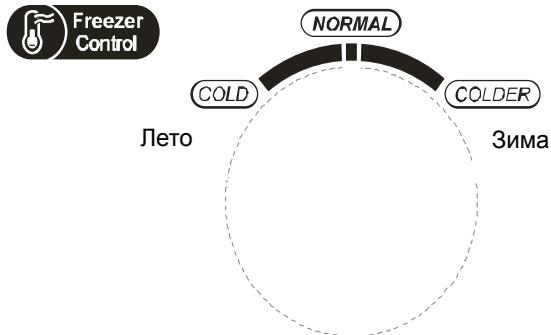
Температурный режим морозильной камеры может выбираться в зависимости от температуры окружающей среды. Обычно достаточно режима NORMAL. В летнее время года, или при повышенной температуре окружающей среды (выше +35 градусов Цельсия) рекомендуется устанавливать режим COLD. Если температура окружающей среды ниже +10 градусов Цельсия, то рекомендуется выбор режима COLDER.
