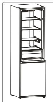
6. Установите верхнюю дверь и верхнюю петлю, не фиксируя её. Отрегулируйте верхнюю дверь, обеспечив её плотное прилегание, и зафиксируйте петлю. Установите декоративную крышку.
