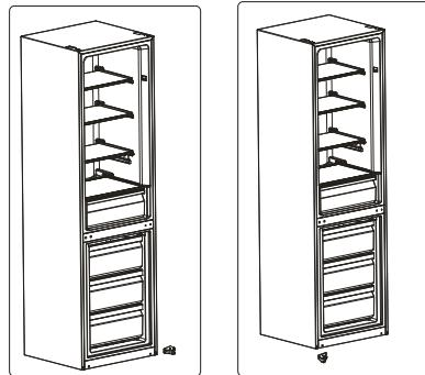
5. Установите нижнюю дверь и среднюю петлю, не фиксируя её. Отрегулируйте дверь, обеспечив плотное прилегание, и зафиксируйте петлю.
