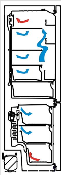
В холодильниках с охлаждением нового поколения применяется другая рабочая система, чем в холодильниках со статической системой. В обычных холодильниках влажный воздух, попадающий в него, а также водяной пар из пищи образует иней в морозильной камере. Для размораживания необходимо выключить холодильник. Пока устройство выключено, чтобы поддержать пищевые продукты в холодном состоянии, пользователь должен извлечь их из холодильника и очистить ото льда.
