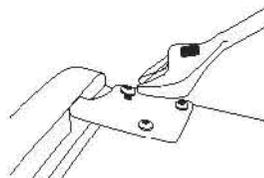
9. Установите верхнюю крышку и затяните ее с помощью винтов.
