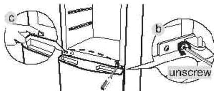
с. Снимите крышки винтов и поместите их на противоположную сторону.
