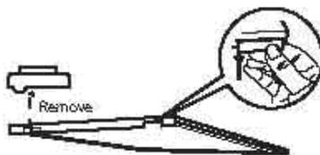
2. а. Открутите винты, приподнимите кронштейн и снимите его.
