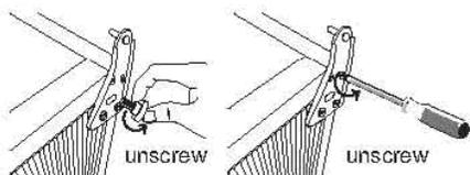
6. Витягніть гвинт з нижнього шарніра і встановіть його на протилежний бік. Помістіть двері морозильної камери назад.
