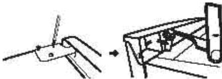
б. Видаліть болт за допомогою викрутки і переверніть шарнірний кронштейн, потім встановіть болт шарнірного кронштейна. Зніміть двері холодильника.
