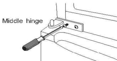
8. Убедитесь, что дверь морозильной камеры выровнена по горизонтали и по вертикали так, чтобы уплотнение прилегло со всех сторон, прежде чем окончательно затянуть петли.
