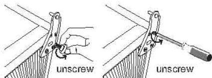
6. Извлеките винт из нижнего шарнира и установите его на противоположную сторону. Поместите дверь морозильной камеры обратно.
